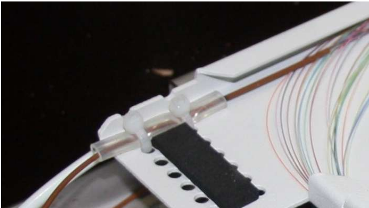
Kuva 7.7.1 Flex-kuituputki kiinnitetty jatkoslevylle.
