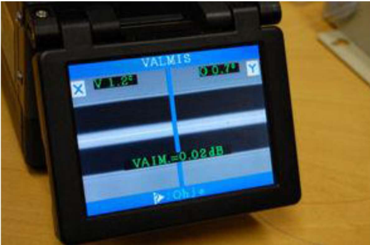
Kuva 7.7.3 Hyväksyttävästä kuituhitsauksesta jatkoskoneen näytöllä
